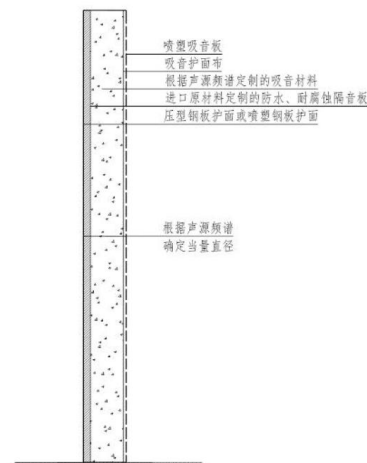
图 7.3-1 吸、隔音屏障结构示意图
